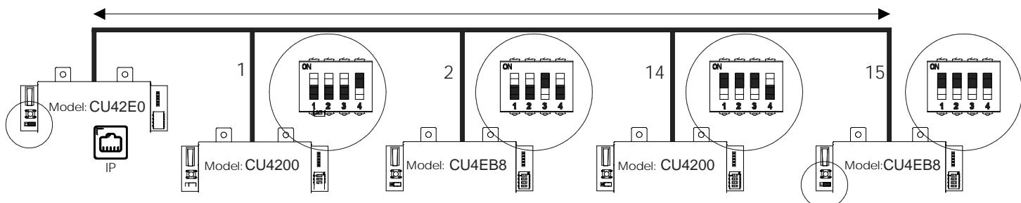
D) Maximale Anzahl der Geräte auf dem BUS485: 16 Geräte, davon maximal 4 CU4200 und 15 CU4EB8.
