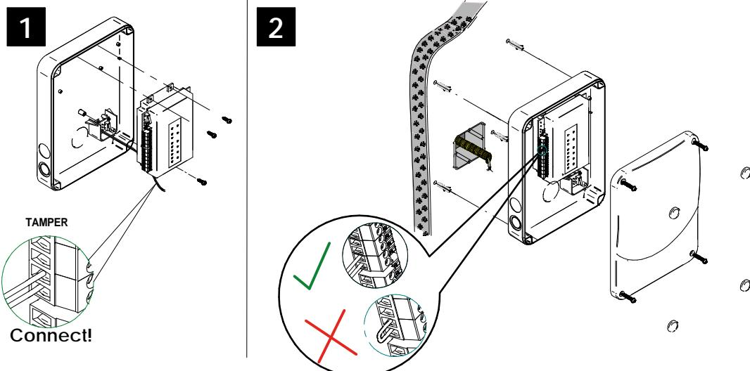
Hinweis: Befolgen Sie das gleiche Anschlussprinzip des Sabotageeingangs der CU, wenn Sie ein elektrisches Gerät eines Drittanbieters verwenden, das mit einer Sabotageüberwachung ausgestattet ist.
